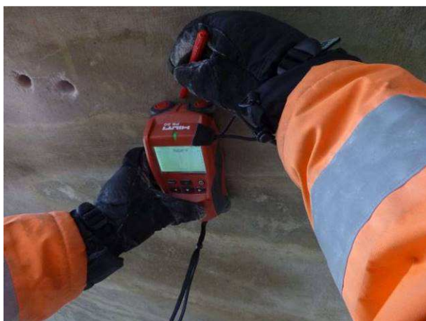
Pohled na detekování kanálků v nosnících.
