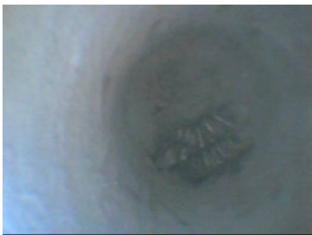
Kanálek 2 - 2 x drát proinjektovaný, bez koroze.
