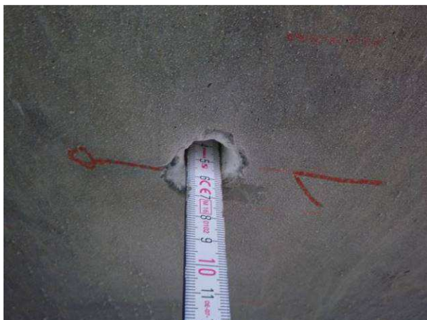
Měření hloubky drátů od spodního líce.
