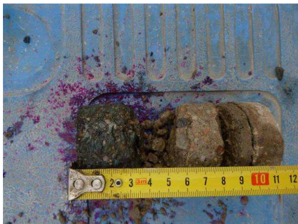
Pohled na skladbu vozovky v sondě 2: Obrus / beton / izolace / beton.
