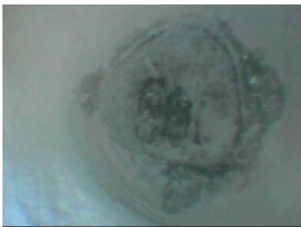
Kanálek 2 - 2 x drát proinjektovaný, mírná povrchová koroze.
