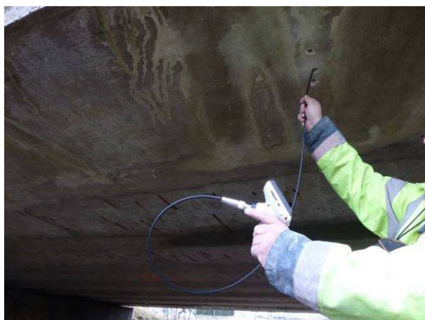
Vizuální prohlídka otevřeného kanálku endoskopem se záznamem.
