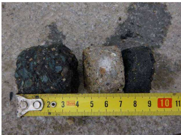
Pohled na skladbu vozovky v sondě 1: Obrus / beton / izolace / - .
