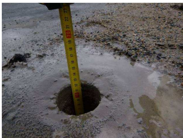
Celková tloušťka souvrství v sondě 1 byla naměřena 120 mm.
