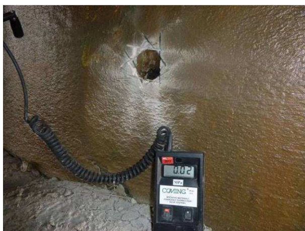
Pohled na zkoušku odtrhovým přístrojem OP1.
